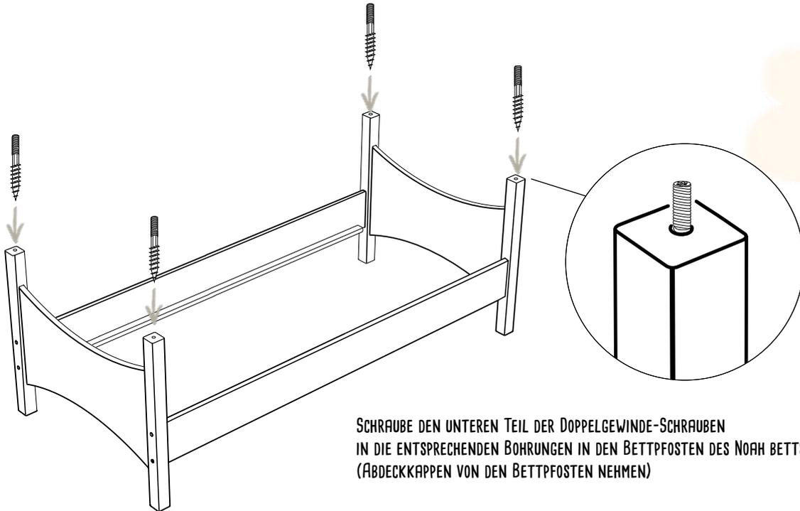
SCHRAUBE DEN UNTEREN TEIL DER DOPPELGEWINDE-SCHRAUBEN
