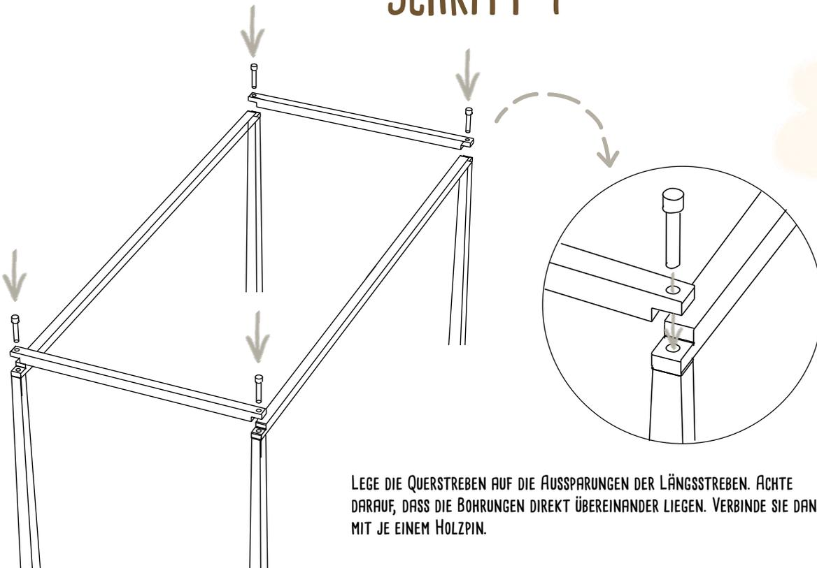
LEGE DIE QUERSTREBEN AUF DIE AUSSPARUNGEN DER LÄNGSSTREBEN. ACHE DARAUF, DASS DIE BOHRUNGEN DIREKT ÜBEREINANDER LIEGEN. VERBINDE SIE DANN MIT JE EINEM HOLZPIN.
