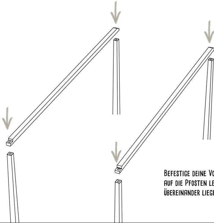
BEFESTIGE DEINE VORHÄNGE AN DEN LÄNGSSTREBEN, BEVOR DU SIE ANSCHLIEßEND AUF DIE PFOSTEN LEGST. ACHE DARAUF, DASS DIE BOHRLÖCHER FÜR DIE HOLZPINS ÜBEREINANDER LIEGEN
