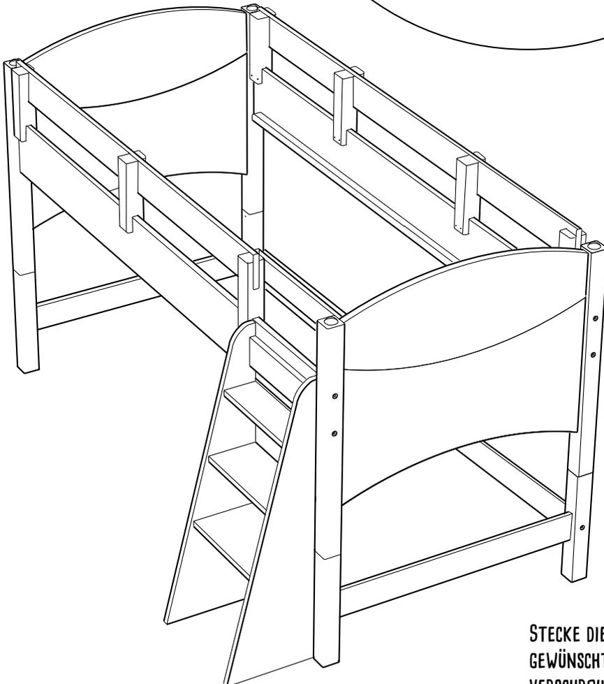
STECKE DIE PFOSTEN DES AUSFALLSCHUTZES AN DER GEWÜNSCHTEN POSITION AUF DIE BETTSEITEN AUF UND VERSCHRAUBE JEDEN PFOSTEN VON INNEN NACH AUSSEN MIT 2 SCHRAUBEN.
