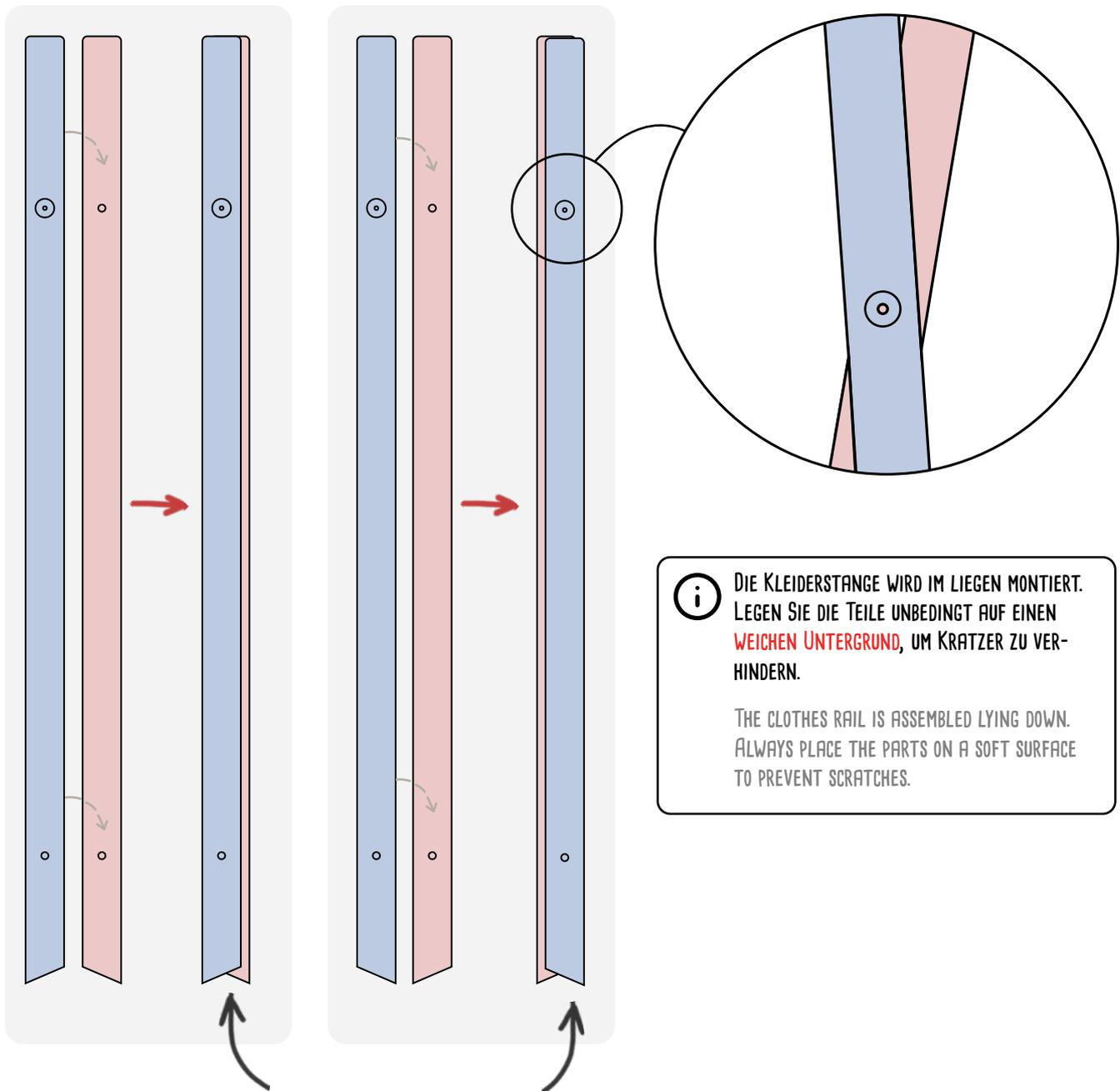
**i** DIE KLEIDERSTANGE WIRD IM LIEGEN MONTIERT. LEGEN SIE DIE TEILE UNBEDINGT AUF EINEN WEICHEN UNTERGRUND, UM KRATZER ZU VERHINDERN.
