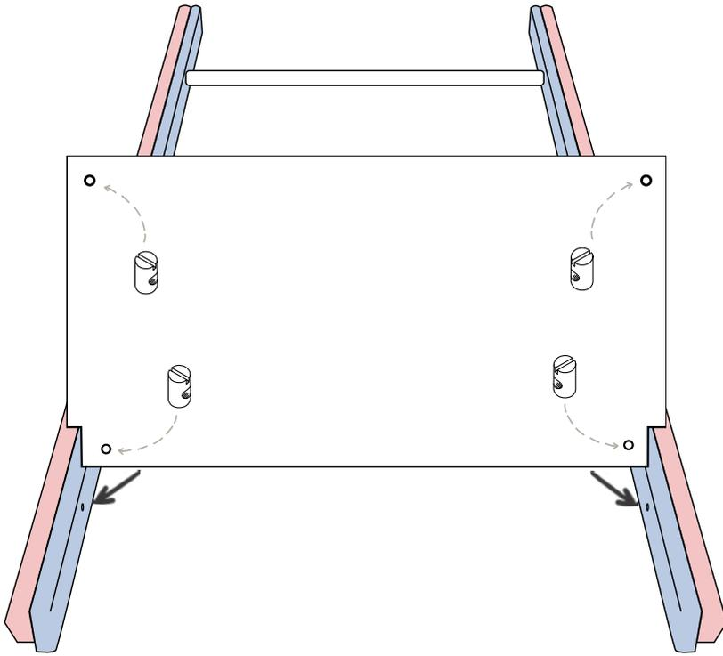
SETZEN SIE NUN DIE QUERMUTTERBOLZEN IN DIE BOHRUNGEN AM BODEN EIN UND SETZEN SIE DEN BODEN WIEDERUM ZWISCHEN DIE BEREITS MONTIERTEN BEINE.
