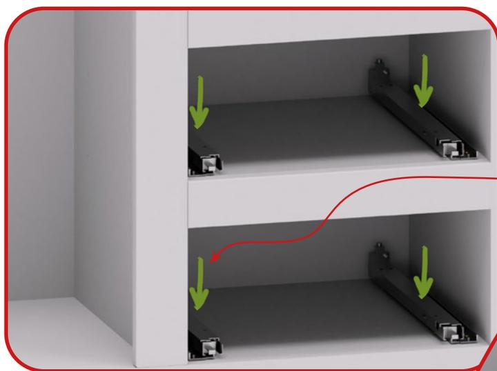
2. VERSCHRAUBEN SIE DIE VIER SCHUBLADENSCHIENEN WIE ABGEBILDET IM KORPUS. SCHRAUBEN SIE SIE MIT DEN VIER HOLZSCHRAUBEN DURCH DIE VORGEBOHRTEN LÖCHER IN DEN ZWISCHENBÖDEN FEST.
