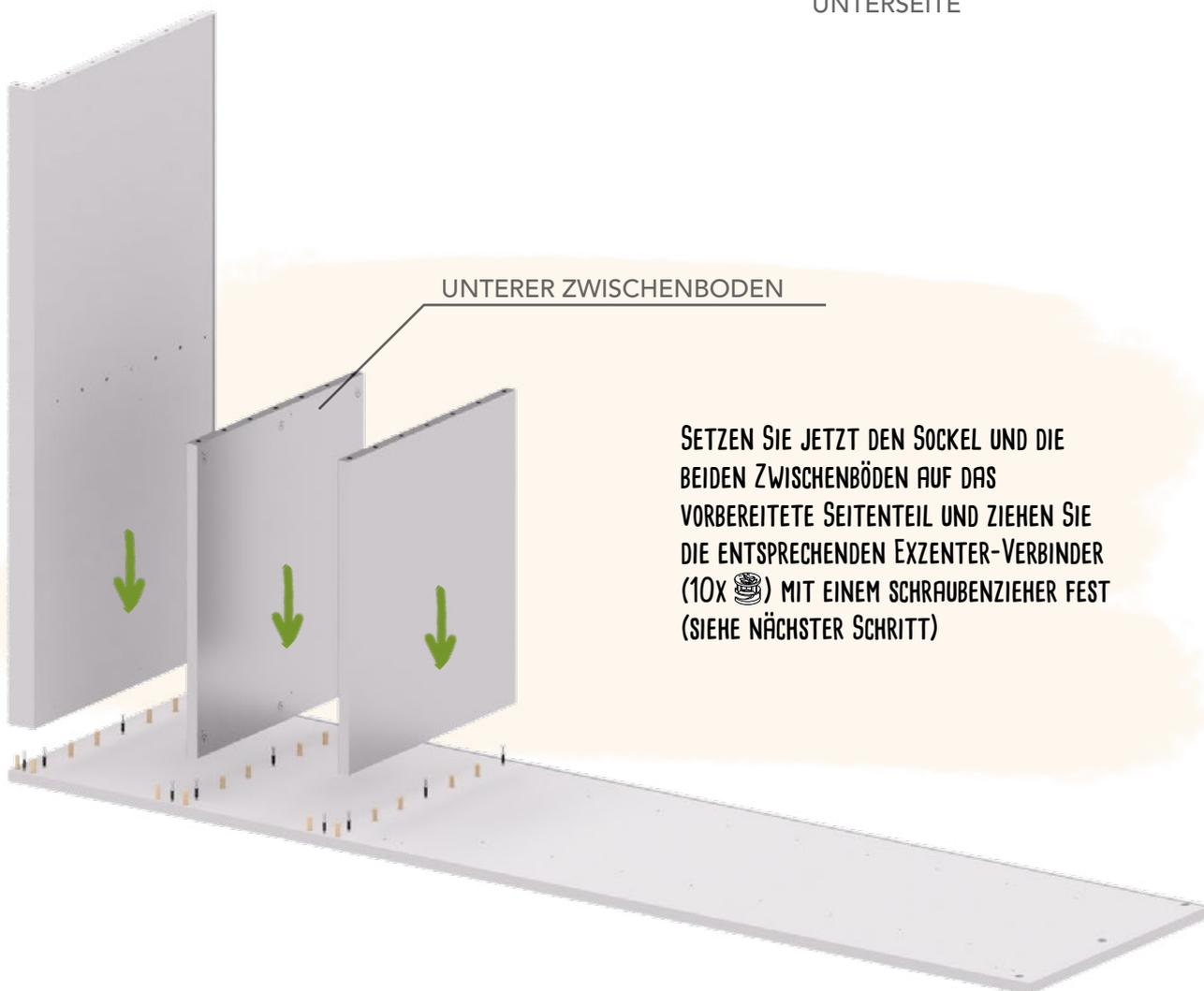
SETZEN SIE JETZT DEN SOCKEL UND DIE BEIDEN ZWISCHENBÖDEN AUF DAS VORBEREITETE SEITENTEIL UND ZIEHEN SIE DIE ENTSPRECHENDEN EXZENTER-VERBINDER (10x
