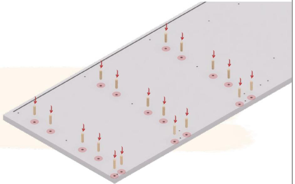
2. VERSCHRAUBEN SIE DIE EXZENTER-DÜBEL AN DEN MARKIERTEN STELLEN IN DIE SEITENWAND.
