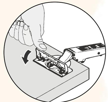
4. SETZEN SIE JETZT DIE SCHARNIERE IN DIE BEIDEN
