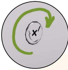
3. ZIEHEN SIE ANSCHLIEßEND DIE EXZENTER MIT EINEM SCHRAUBENZIEHER FEST, SODASS DIE TEILE FEST MITEINANDER VERBUNDEN SIND.
