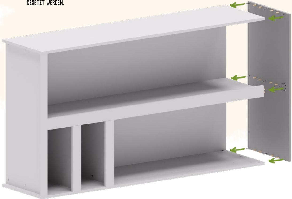
2. ZIEHEN SIE ANSCHLIEßEND ALLE EXZENTER-VERBINDER MIT EINEM SCHRAUBENZIEHER FEST.
