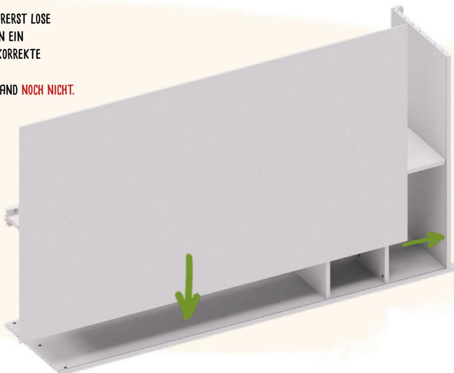
2. SETZEN SIE DIE LINKE SEITENWAND VORSICHTIG AUF. ACHTEN SIE DARAUF, DASS DÜBEL, EXZENTER UND VERBINDER KORREKT AUSGERICHTET SIND UND INEINANDER PASSEN.
