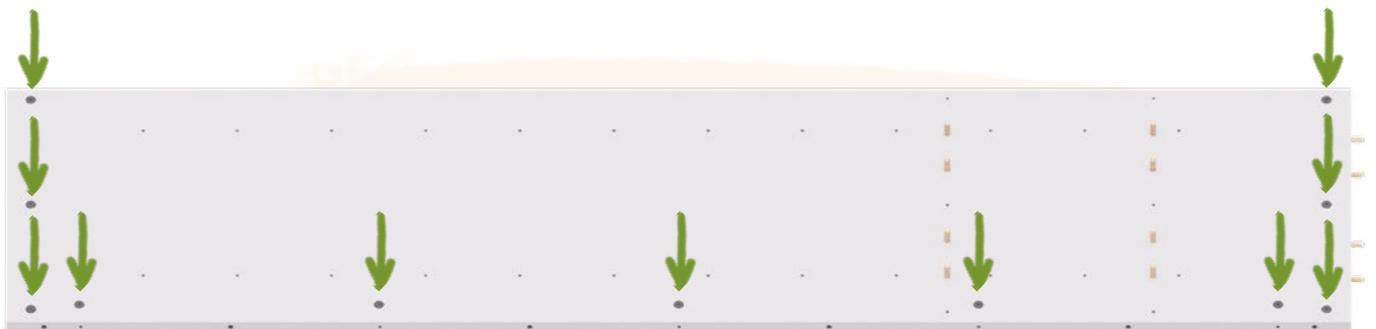
2. SETZEN SIE DIE EXZENTER-VERBINDER IN DIE MARKIERTEN BOHRUNGEN. ACHTEN SIE DARAUF, DASS DER KLEINE PFEIL IN RICHTUNG AUßENKANTE ZEIGT.
