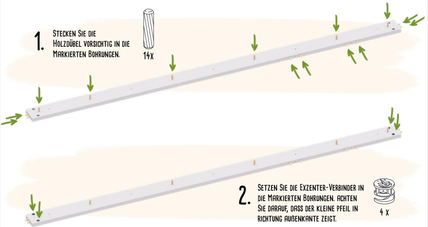
2. SETZEN SIE DIE EXZENTER-VERBINDER IN DIE MARKIERTEN BOHRUNGEN. ACHTEN SIE DARAUF, DASS DER KLEINE PFEIL IN RICHTUNG AUßENKANTE ZEIGT.
