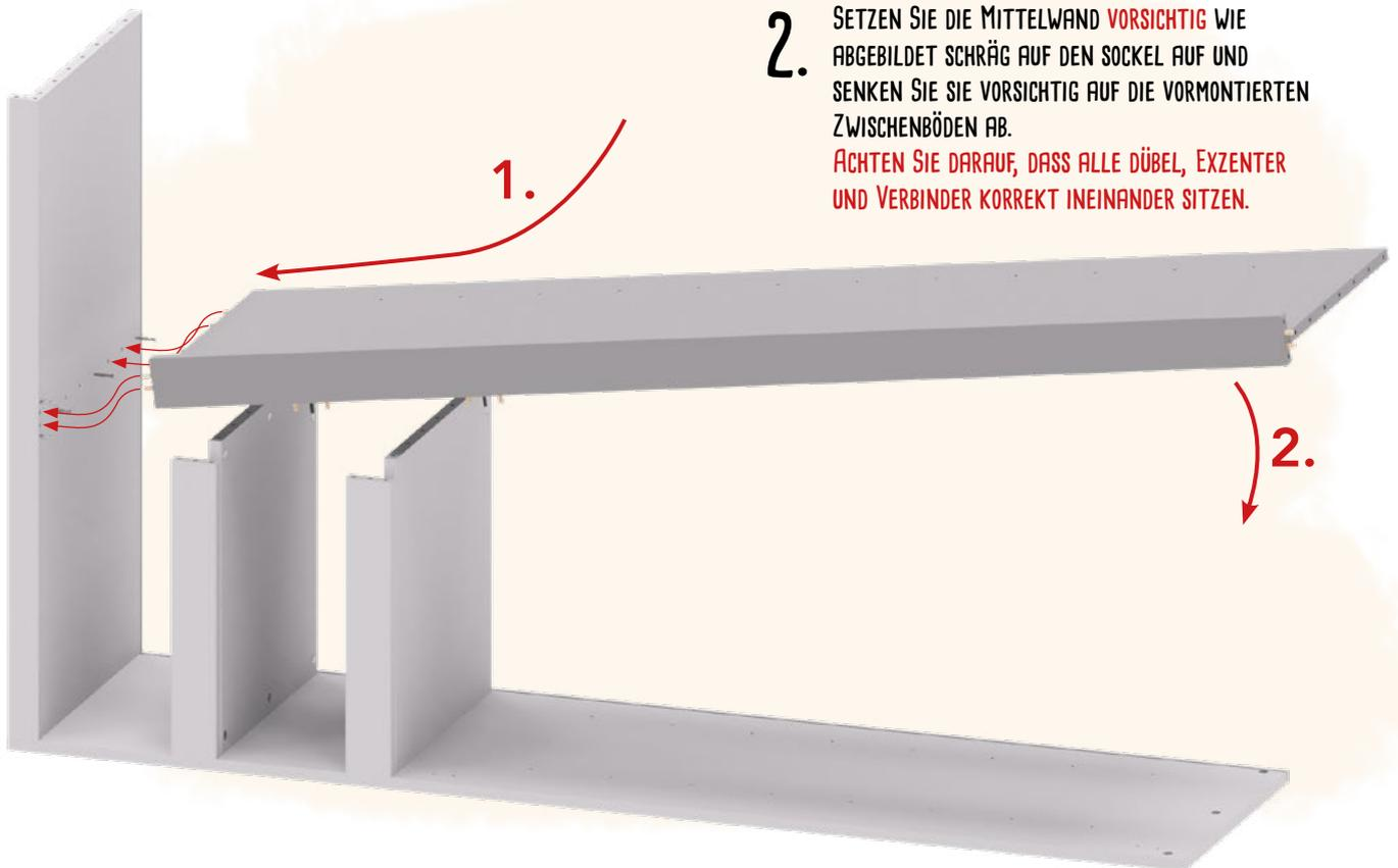
2. SETZEN SIE DIE MITTELWAND **VORSICHTIG** WIE ABGEBILDET SCHRÄG AUF DEN SOCKEL AUF UND SENKEN SIE SIE VORSICHTIG AUF DIE VORMONTIERTEN ZWISCHENBÖDEN AB.
