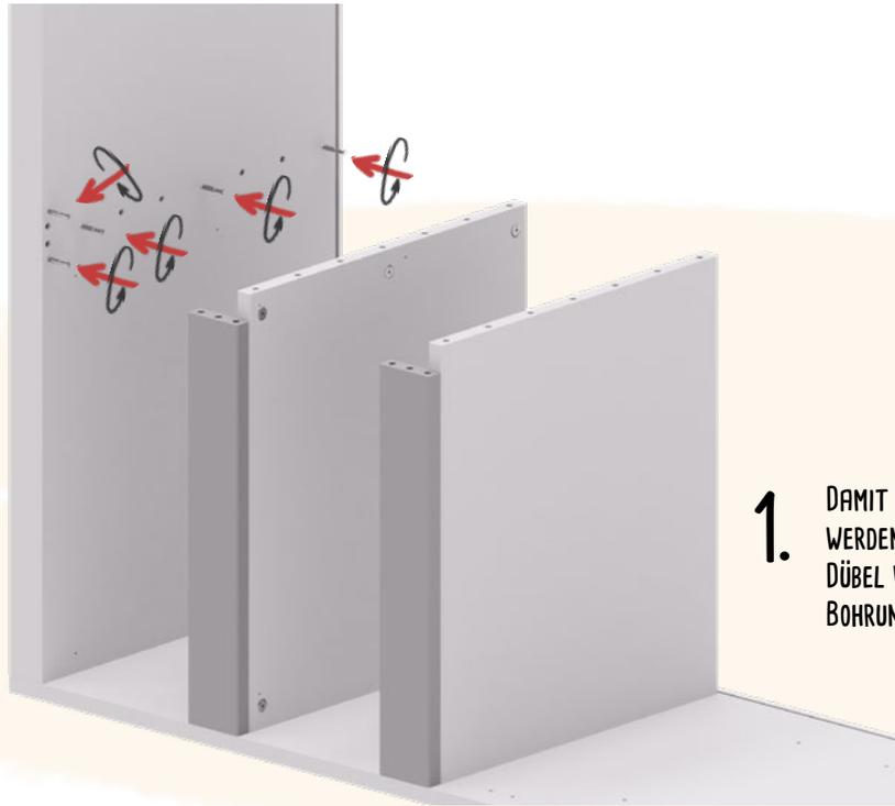
1. DAMIT DIE MONTIERTE MITTELWAND EINGESETZT WERDEN KANN, SCHRAUBEN SIE SECHS EXZENTER-DÜBEL WIE ABGEBILDET IN DIE VORBEREITETEN BOHRUNGEN DES SOCKELS.
