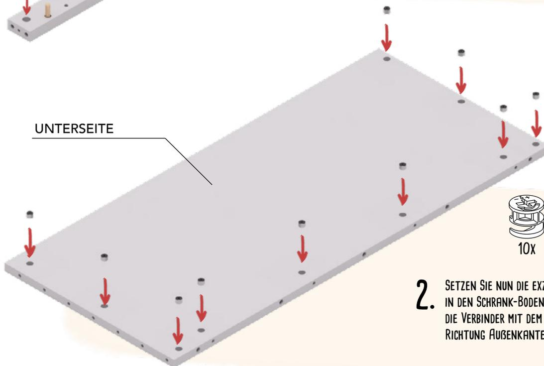
2. SETZEN SIE NUN DIE EXZENTER-VERBINDER IN DEN SCHRANK-BODEN EIN. RICHTEN SIE DIE VERBINDER MIT DEM KLEINEN PFEIL IN RICHTUNG AUßENKANTE AUS.
