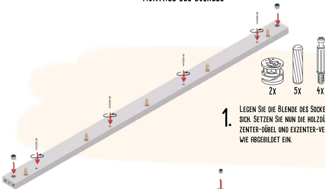
1. LEGEN SIE DIE BLENDE DES SOCKELS VOR SICH. SETZEN SIE NUN DIE HOLZDÜBEL, EXZENTER-DÜBEL UND EXZENTER-VERBINDER WIE ABGEBILDET EIN.
